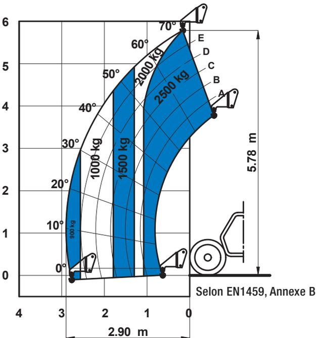
Sur pneus avec fléchette 2 m (mécanique)
